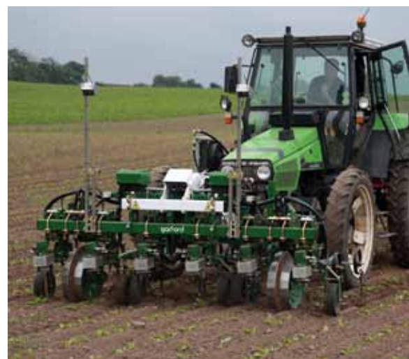
Mekanisk renholdelse af roer med lugerobot.
